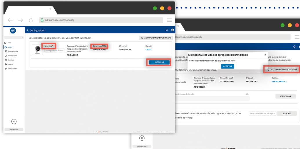
• Su PC debe estar conectado a la misma red que la cámara. Ésta aparecerá como dispositivo para instalar. Introduzca el nombre, compruebe que la dirección MAC es la correcta (es el número que aparece en el propio dispositivo), pulse **'Instalar'** y siga los pasos que le indica.
